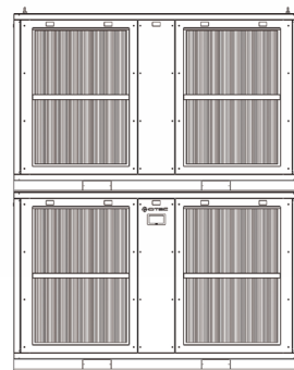
CFAC 200 CEH/ 100kW N+1 冗長構成
